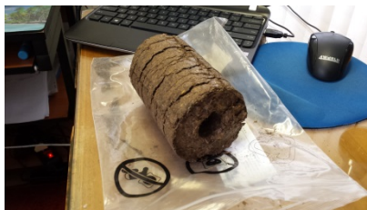
Fot. 4. Brykietarka jednogłowicowa oraz brykiet wykonany z pofermentu o wilgotności ok. 30% (fot. zbiory Zakładu OZE/ITP)
