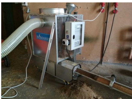
Fot. 4. Brykietarka jednogłowicowa oraz brykiet wykonany z pofermentu o wilgotności ok. 30% (fot. zbiory Zakładu OZE/ITP)
