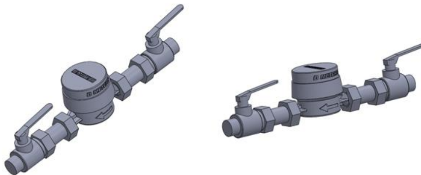
Fot. 7.1. Montaż przepływomierza z zaworami odcinającymi na rurociągu
