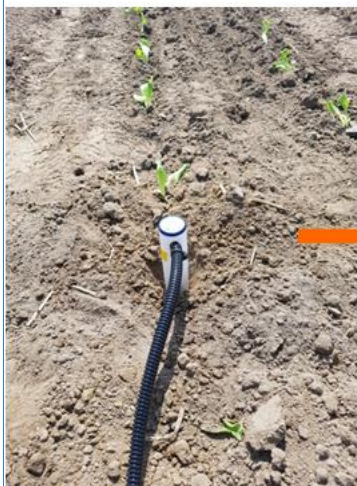
sonda profilowa do pomiaru wilgotności gleby Drill&Drop
