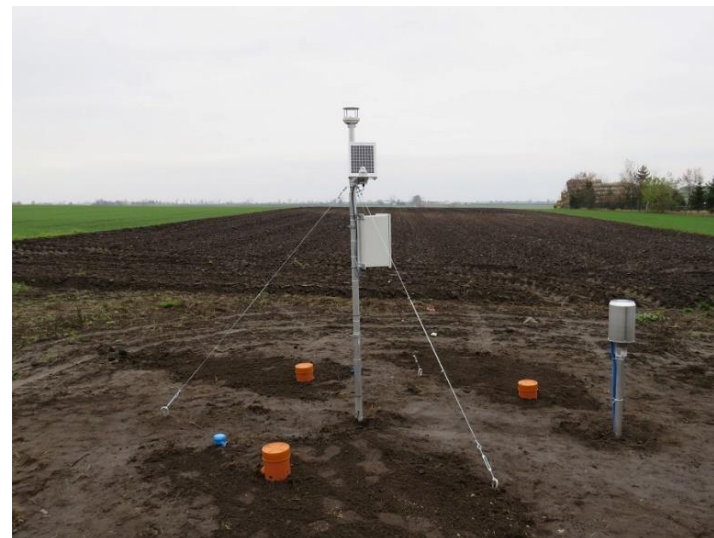
Automatyczna stacja meteorologiczna z transmisją danych
