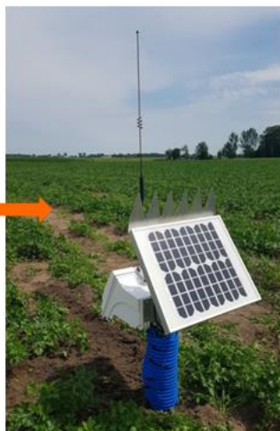
moduł komunikacji bezprzewodowej Sentek PLUS
