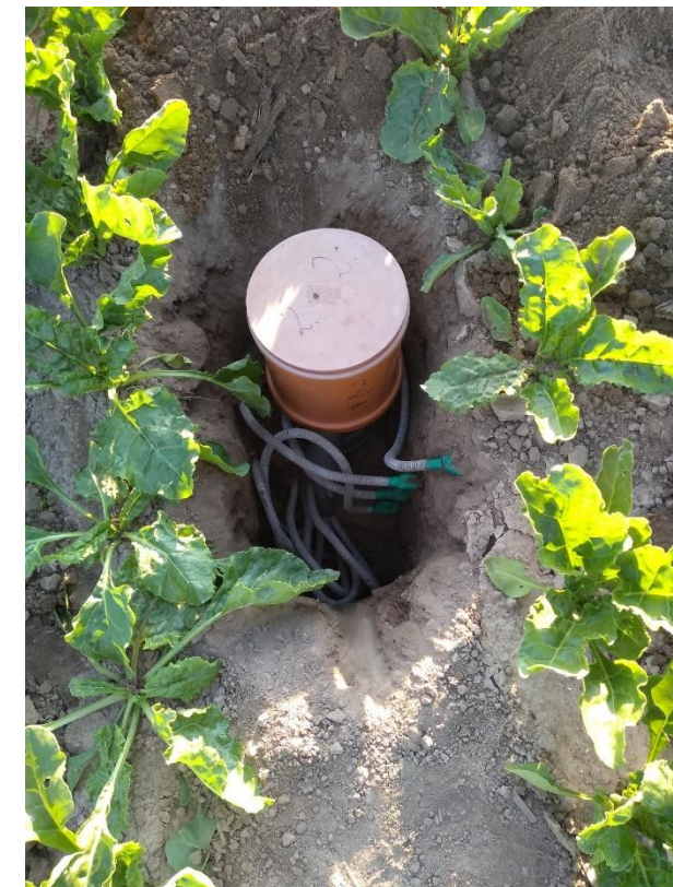
Czujnik wilgotności gleby ECH 2 O typu EC-5
