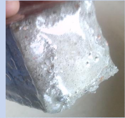
Warstwa ochrony powierzchniowej wykonana z żywicy epoksydowej widoczna na powierzchni próbki
