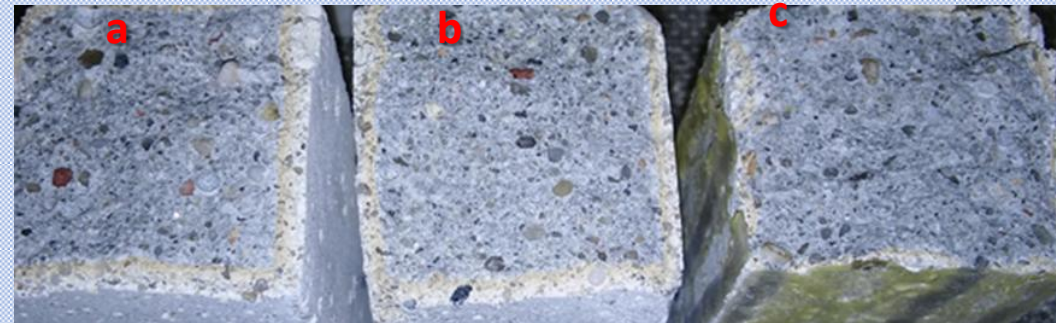
Próbki; od lewej: a-brak impregnacji, b-impregnacja szkłem wodnym, c-impregnacja żywicą epoksydową
