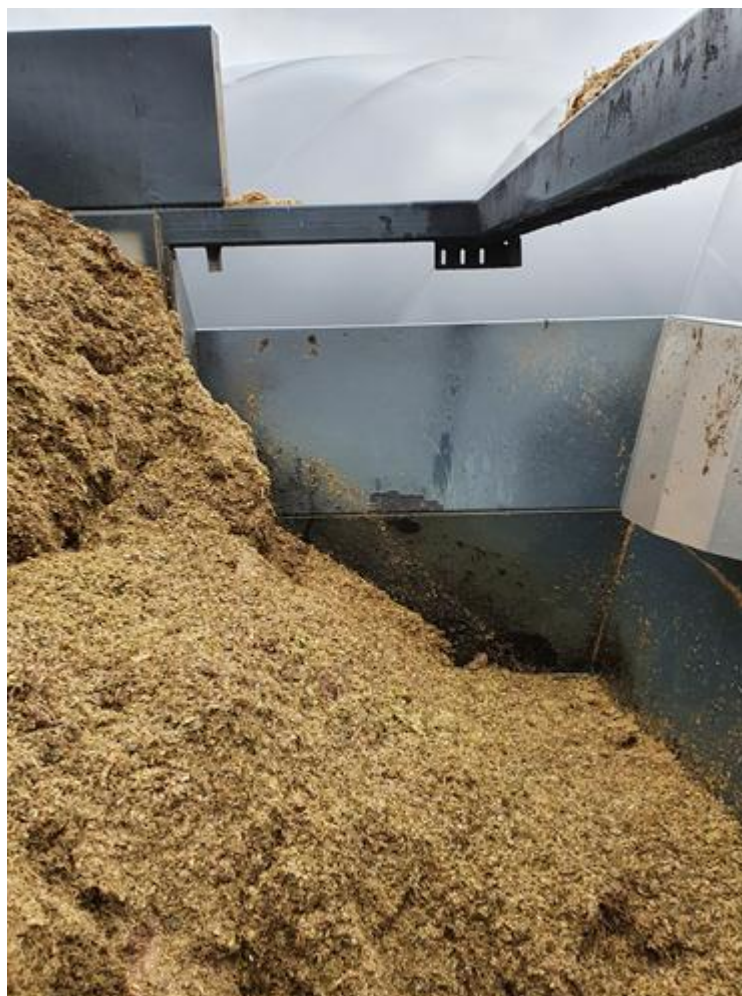
Rys. 2.1. Dozownik automatyczny substratu stałego [zdjęcie własne]
